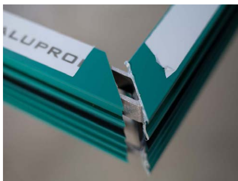
6 Upravené profily připravené na spojení
