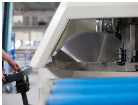
3 Dělení profilů na dvouhlavé úhlové pile vč. možnosti oboustranných 3D řezů
