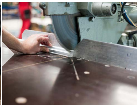
10 Nářez zasklívací lišty (zasklívá se obvykle až při montáži - na stavbě)
