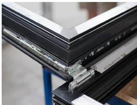
9 Okno po osazení těsněním a kováním
