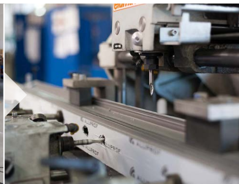
5 Vrtání, popř. frézování technologických otvorů např. pro okenní kliky anebo dveřní zámky
