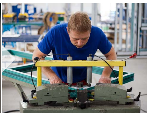
7 Spojování profilů – v tomto případě lisováním
