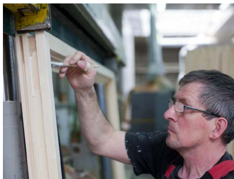
3 Klížení - odstraňování přebytků lepidla
