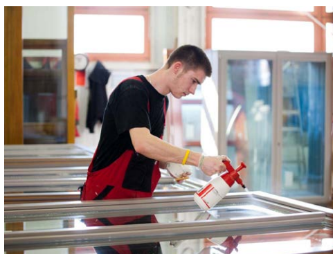
9 Zasklívání - příprava před stíráním silikonu
