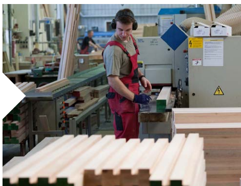
1 Jedna ze základních operací - čtyřstranné hoblování včetně kalibrace
