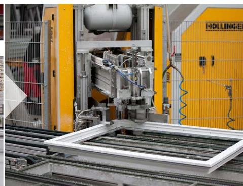
5 Automatické začištění sváru - odstranění svařovacího přetoku (tzv. housenka)
