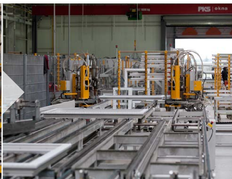
4 Automatický posun polotovaru - za současného chlazení po svařování
