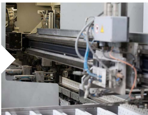
1 Vkládání materiálu do obráběcího centra.
